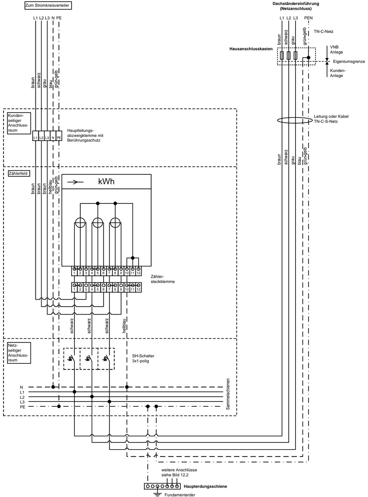
Bild 5.2 Anschlussschema Kabelhausanschluss
