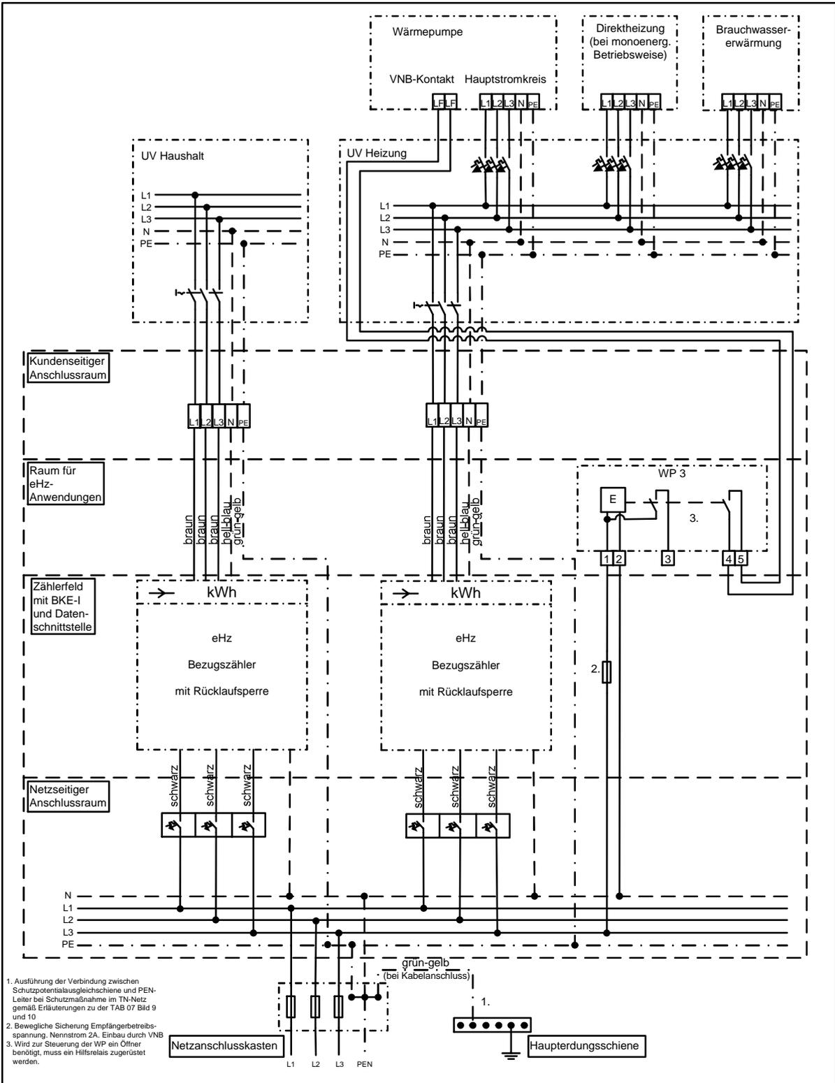
1. Ausführung der Verbindung zwischen Schutzpotentialausgleichschiene und PEN-Leiter bei Schutzmaßnahme im TN-Netz gemäß Erläuterungen zu der TAB 07 Bild 9 und 10
