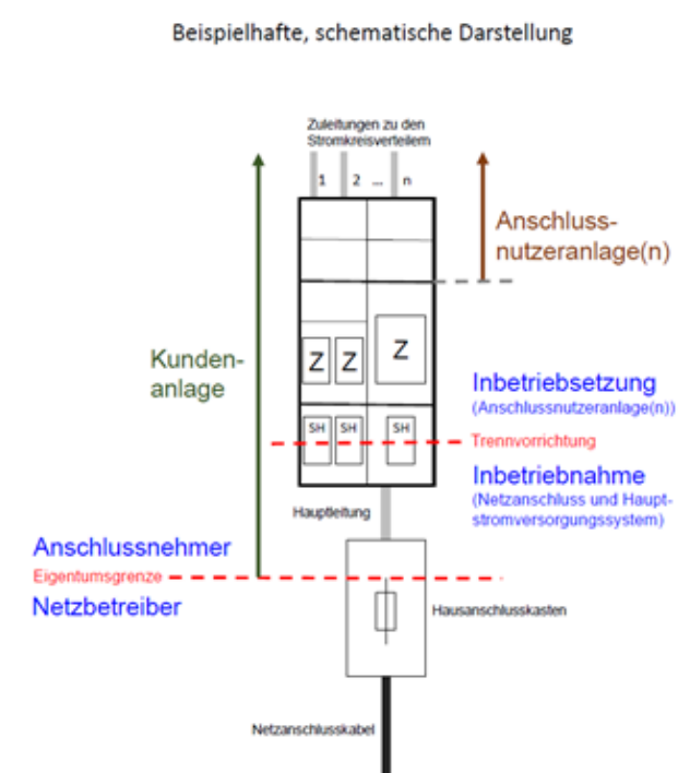
Abbildung 1 – schematische Darstellung der Begriffe Inbetriebnahme / Inbetriebsetzung sowie Kundenanlage / Anschlussnutzeranlage
